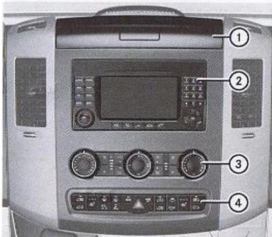
Abbildung 14: Mittelkonsole mit Bedieneinheiten
