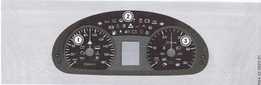
Abbildung 13: Warn- und Kontrollleuchten im Kombiinstrument
