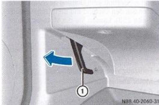
Abbildung 27: Entriegelungsgriff für die Motorhaube
